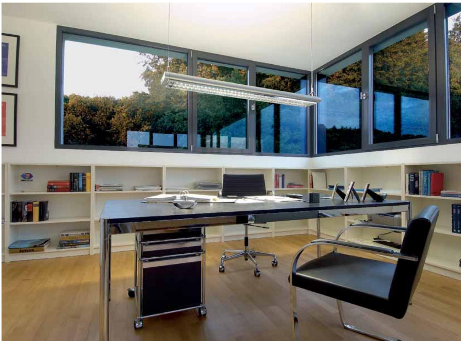
Diese Pendelleuchte ist mit einem für Bildschirmarbeitsplätze geeigneten Darklight-Raster nach DIN 5035-7 ausgestattet. Damit sind blendfreies Licht und ein optimal ausgeleuchteter Arbeitsplatz möglich.
